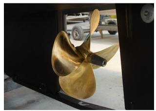
En générale ces hélice haute performance présentent un pouce de plus en pas, du skew-back (courbure des palles vers l'arrière à leur extrémité en forme de boomerang) et pour les vitesses supérieures à 30 nœuds du cup (bordures arrière des pales recourbée).
